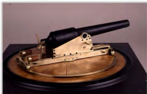
Modelo del montaje de 124,62 mm. en reducto del cañón rayado sistema Parrot (Biblioteca Virtual de Defensa. MNM-1612).
